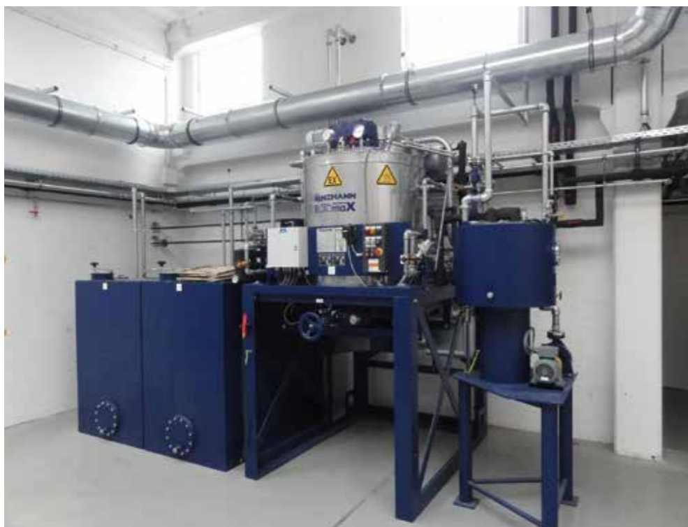
Destillieranlage ROTOMax zur Wiederaufbereitung verschmutzter Lösemittel mit zwei Behälter für die Bevorratung verschmutzter und gereinigter Lösemittel
