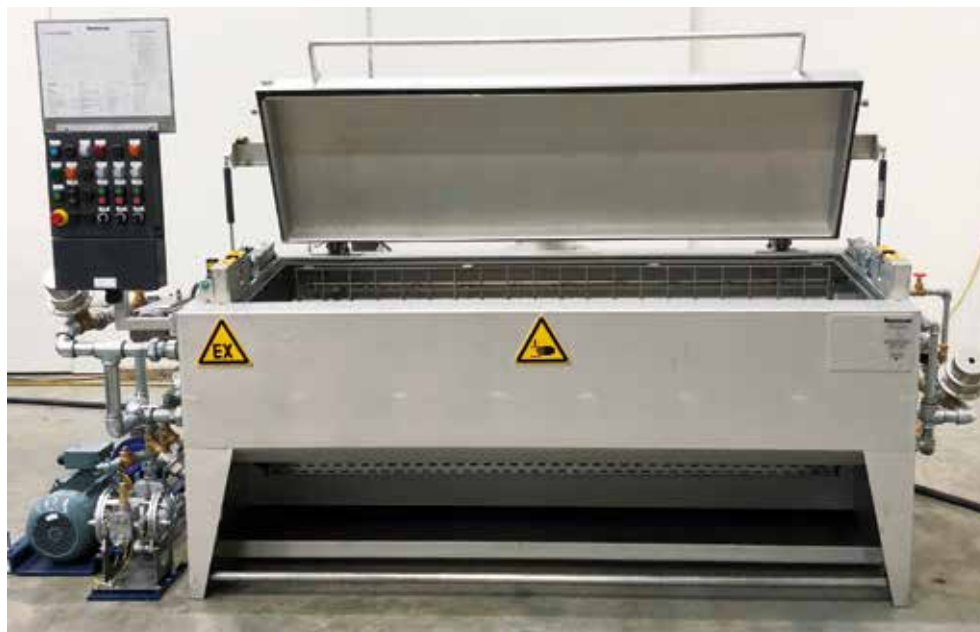
Die Waschmaschine CLEANflex-ex reinigt mit Lösemitteln bei Flammpunkten < 55° C
