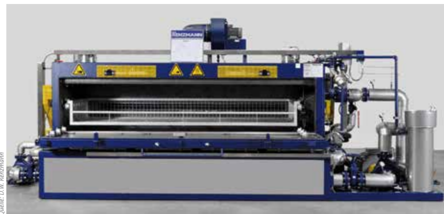
Die Waschmaschine Typ 3500 bietet eine doppelte Beladefähigkeit mit Druckwerksteilen durch eine entsprechend größere Tiefe von Waschkorb und Waschkabine, ein Waschspritzsystem mit doppelter Kapazität, wahlweise eine zweite Beladeöffnung sowie eine zweite Hubtür
